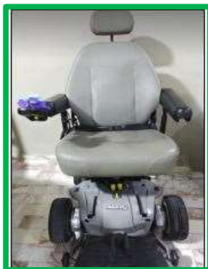
Figura 3. Silla eléctrica con la adaptación propuesta.
