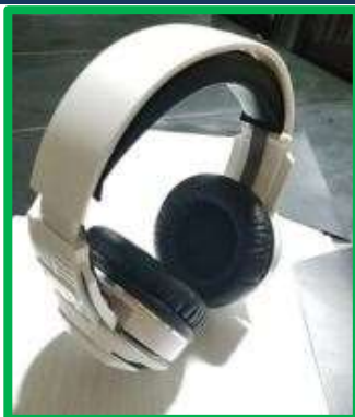
Figura 1. Diadema adaptada para la recepción de comandos de voz.
